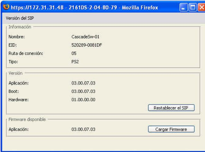
En aquellos casos en los que el conmutador de consola remota no reconozca un conmutador interconectado, puede ser necesario restablecer el SIP que conecta el conmutador interconectado al conmutador de consola remota. Esta operación puede realizarse con el botón **Restablecer el SIP** de la subcategoría **SIP**.
