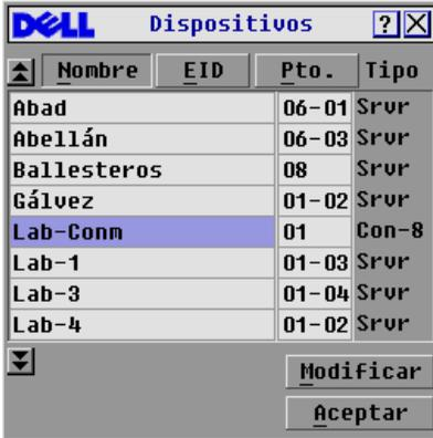
Cuando el conmutador de consola descubre un conmutador conectado en cascada, la enumeración de puertos cambia para admitir a todos los dispositivos situados por debajo de ese conmutador. Por ejemplo, si el conmutador está conectado al puerto ARI 6, el puerto del conmutador se numerará como 06 y cada dispositivo que se encuentre por debajo del mismo se numerará secuencialmente 06-01, 06-02, etc.
